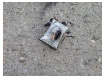
Durch eine zweite Explosion wurde der Akkukern aus dem Gehäuse geschleudert.
